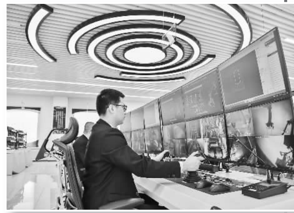
青岛港干散货码头自动化改造后,门机司机只需在控制室就能完成相关工作。
